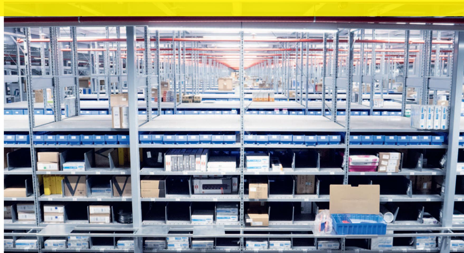
Ein Teil der vorhandenen Fachbodenregale R3000 für kleine bis mittelvolumige Waren wurde zu einer begehbaren Bühnenanlage ausgebaut.
