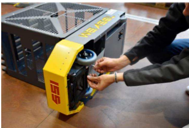
Abb. 11 | Entfernung der Transportsicherung
